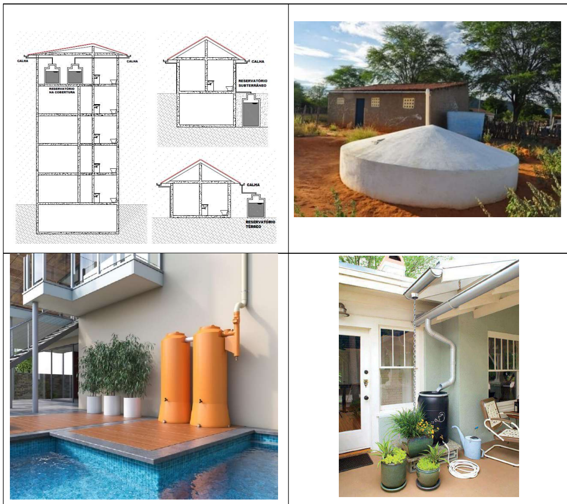
Figura 11 – microrreservatórios de águas pluviais
