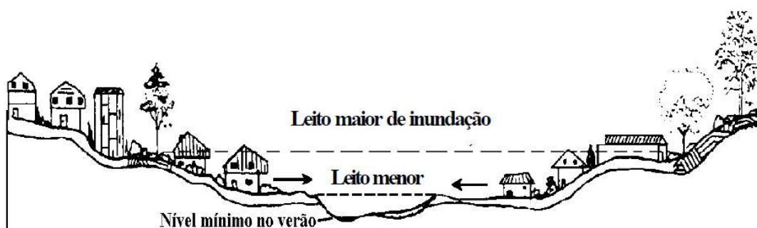
Figura 5 – Características dos leitos dos rios
