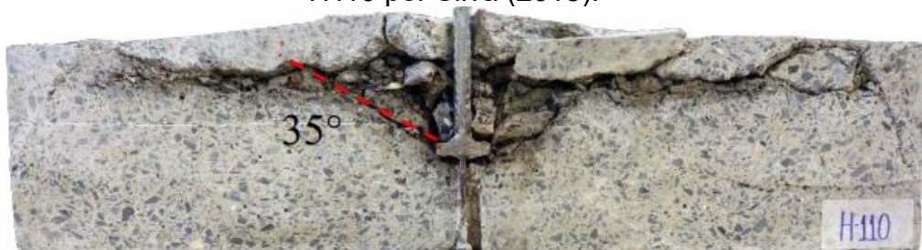
Figura 36 – Corte transversal da superfície de ruptura do espécime H110 por Silva (2018).
