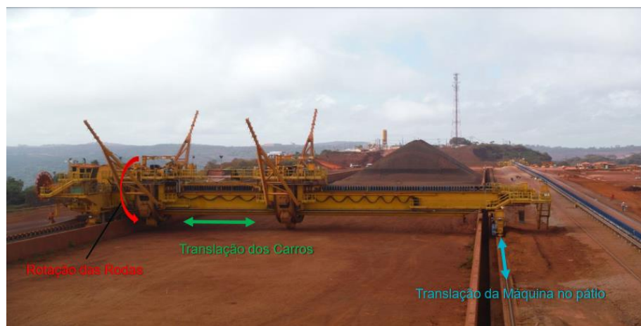
Figura 11 – Movimentos de uma máquina recuperadora do tipo ponte
