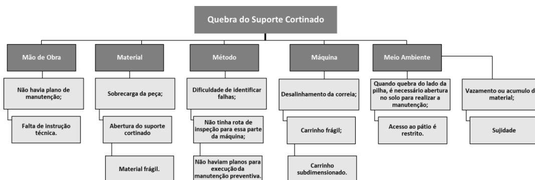
Figura 8- Diagrama de Ishikawa + 5 porquês – Quebra do Suporte Cortinado
