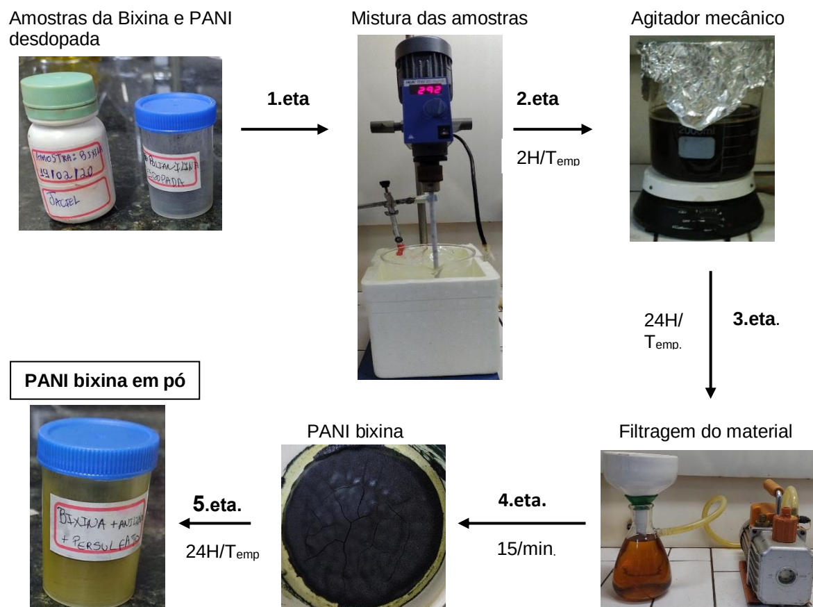
Figura 17. Obtenção da PANI bixina em pó
