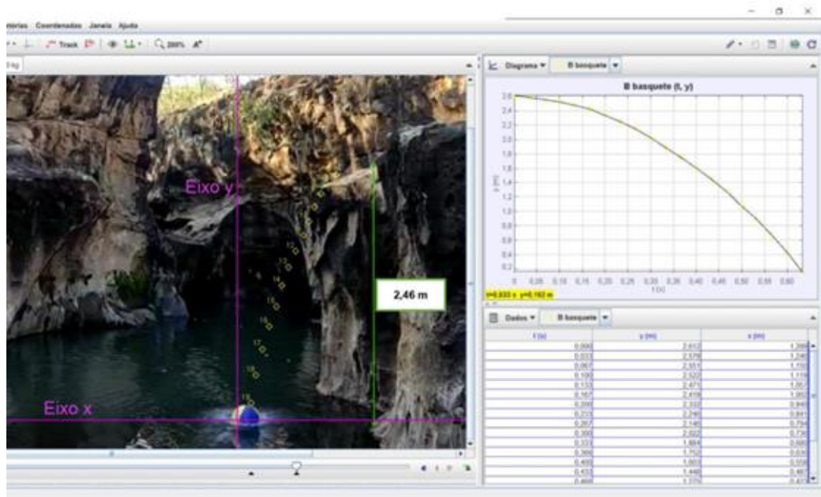
Figura 11 - Análise de um lançamento horizontal no Sucavão.
