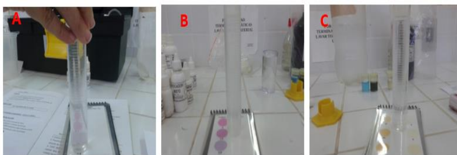
Figura 13: Amostra de água na determinação do teor de oxigênio consumido: Amostra A , Amostra B e Amostra C de água.
