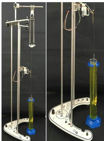
Figura 29: Tripe com sapatas niveladoras, sustentando o oscilador amortecido, com a sua massa emersa no detergente. Fonde do autor
