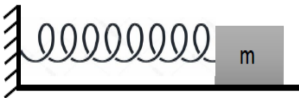
Figura 2: Sistema massa mola proposto. Fonte: Elaborada pelo autor.
