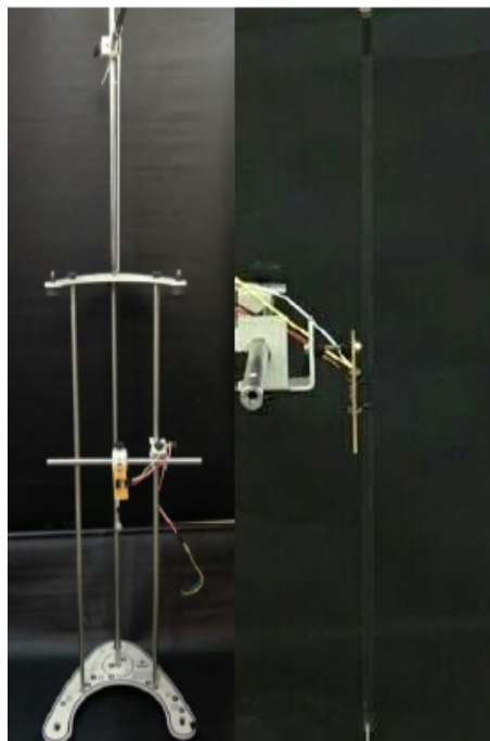
Figura 30: Arranjo utilizado no teste de queda na água. Fonte: elaborada pelo autor
