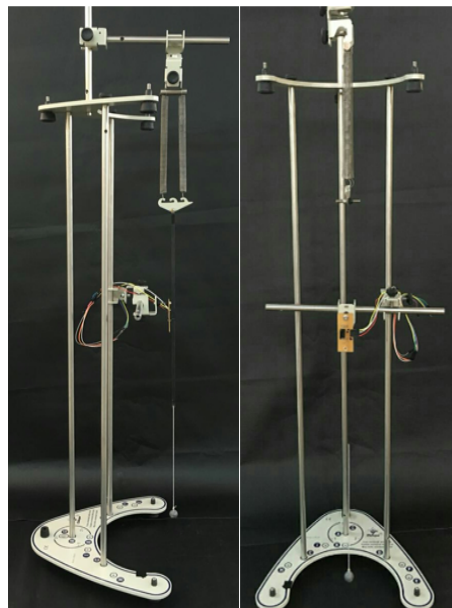
Figura 27: Tripe universal delta Max com sapatas niveladoras, utilizado como suporte para o oscilador amortecido. Fonte: Elaborado pelo autor.
