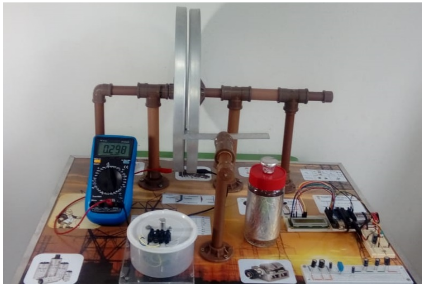
Figura 16 – Representação do kit didático para o ensino do conteúdo de capacitores no ensino médio. Fonte: Autoria própria.
