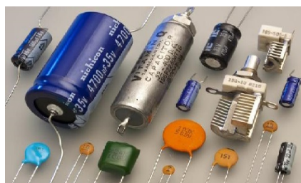
Figura 4 – Imagem ilustrativa de vários tipos de capacitores comerciais. Disponível em: < www.eletronicaparatodos.com >. Acesso em: 18 nov. 2018.
