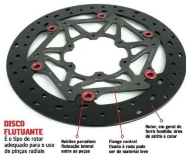
Figura 21 – Disco de freio do tipo flutuante
