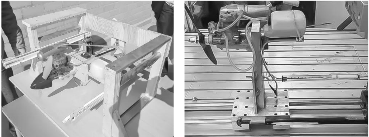
Figura 2 - Bancadas de teste; (a) configuração em gaveta; (b) configuração de deslizamento no trilho.
