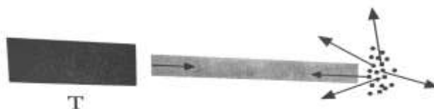
Figura 29: Reflexão difusa de um feixe ultrassônico, T é aparelho Transdutor. Retirada de (GARCIA, 2015).
