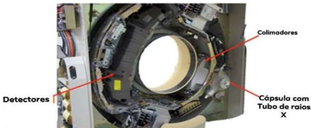
Figura 27: Parte interna do Gantry de um aparelho de tomografia computadorizada. Retirada de (BIASOLI, 2016).
