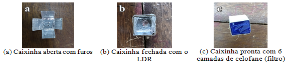
Figura 18: Primeira etapa de montagem. Fonte: Autoria Própria
