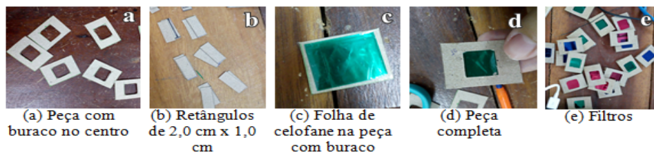
Figura 19: Segunda etapa de montagem. Fonte: Autoria Própria
