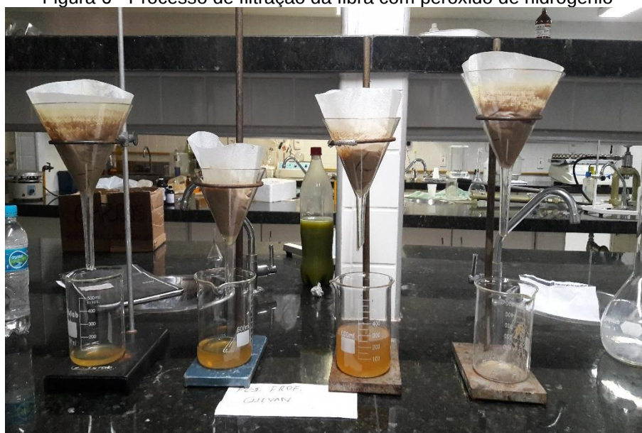
Figura 6 - Processo de filtração da fibra com peróxido de hidrogênio
