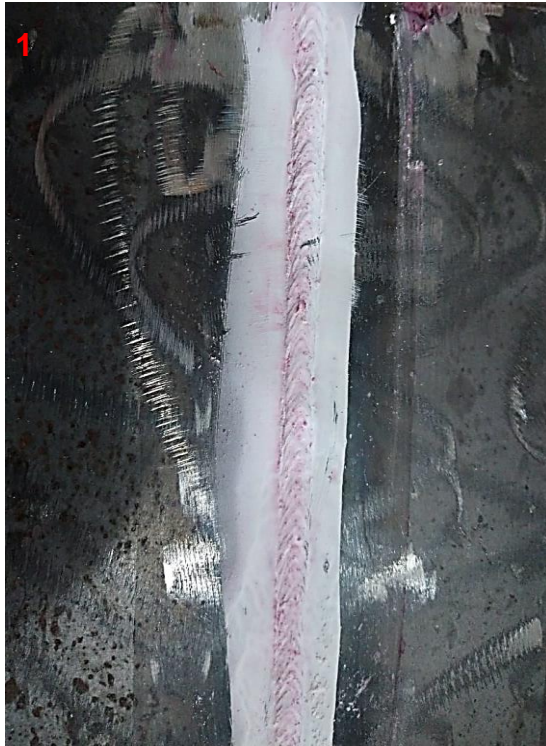
Figura 7: Corpos de prova submetidos ao ensaio de líquido penetrante dos soldadores 1, 2, 3 e 4, respectivamente.
