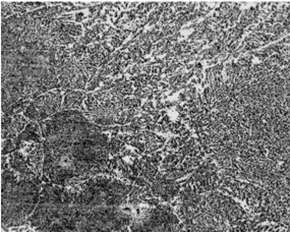
C: Interfase entre os cordões (Eletrodo Revestido e MIG/MAG). Aumento de 100x.
