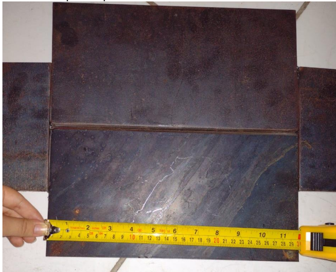
Figura 4 — Corpo de prova de acordo com ABNT NBR 16161/2019.
