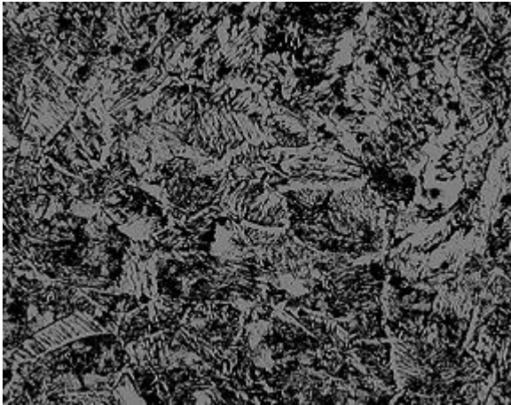
A: Parte superior do cordão obtido pelo processo MIG. Aumento de 100x.
