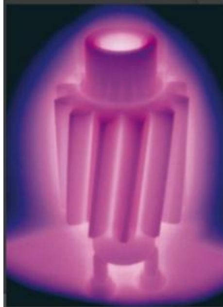
Figura 2 - Formação de descarga brilhante (bainha de plasma) na nitretação. (NITRION BRASIL, 2019)
