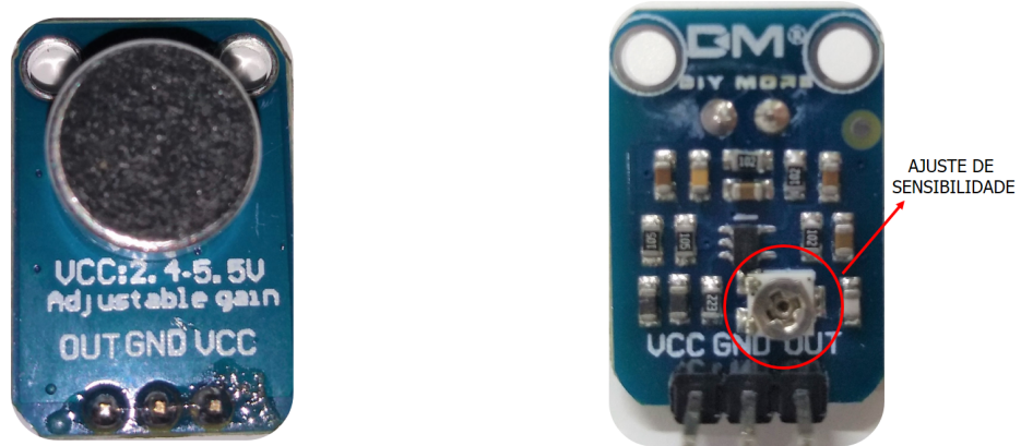
(a) Parte da frente do circuito integrado. (b) Parte de trás com detalhe para o potenciômetro que permite o ajuste de ganho.
