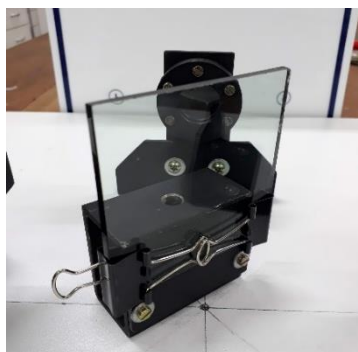
Figura 13 – Suporte e espelho semi-refletor (divisor de feixes)
