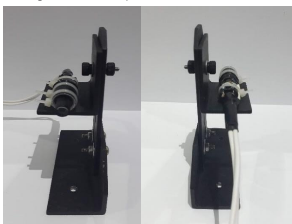
Figura 12 – Suporte e caneta laser
