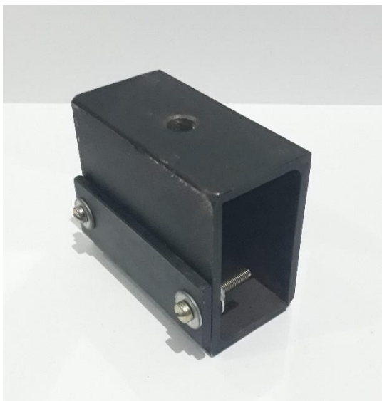
Figura 9 – Suporte do espelho divisor de feixes
