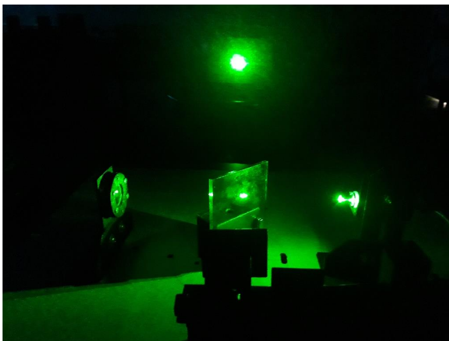
Figura 15 – Incidência da luz laser no espelho semi-refletor
