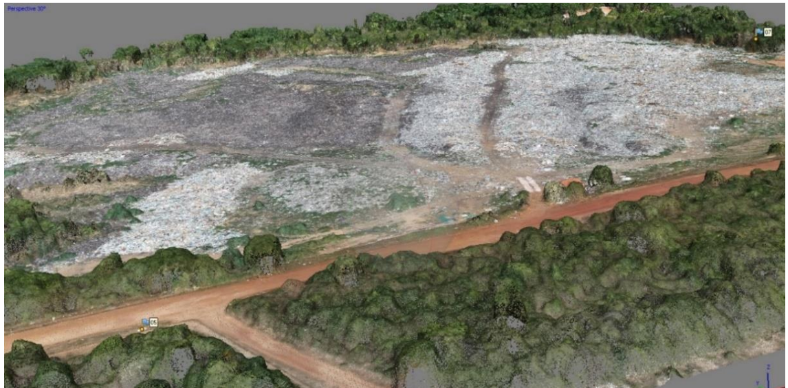
Figura 8: Nuvem de pontos 1 do Lixão de Pedro II- PI
