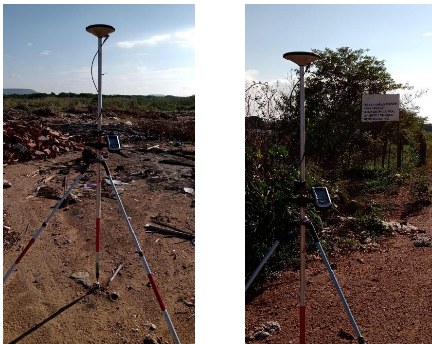
Figura 5: Receptor Promark 220 Geodésico coletando Pontos de Apoio/Check
