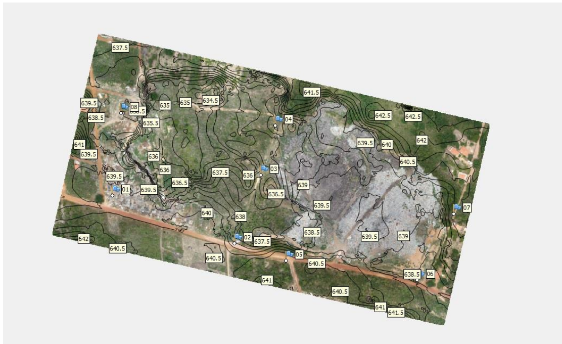
Figura 19: Ortofoto com sobreposição de curvas de nível
