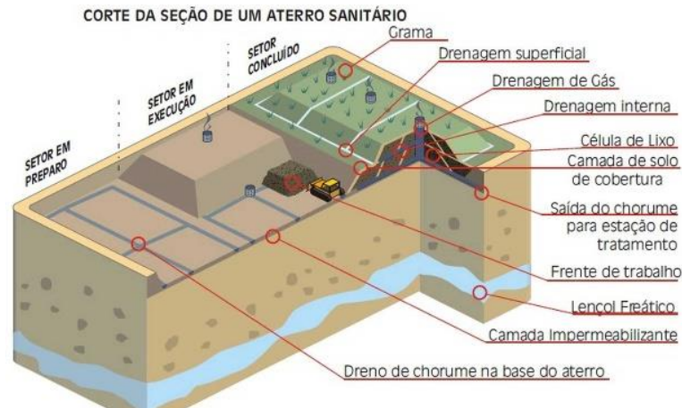
Figura 3: Componentes de um Aterro Sanitário
