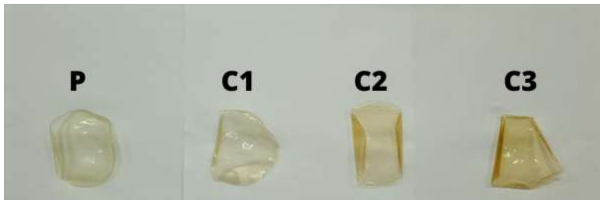
Figura 14: Degradação das membranas após 144 dias.
