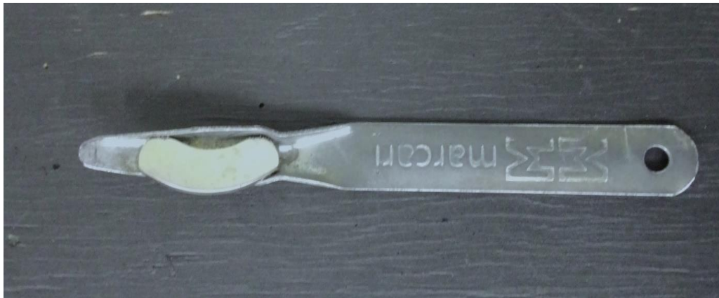
Figura 7.3: Imã acoplado a uma barra de metal
