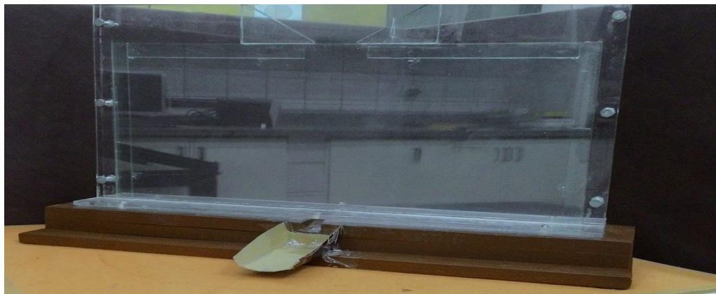
Figura 7.1: Silo de acrílico formado por placas paralelas e base retangular de largura w = 165d
