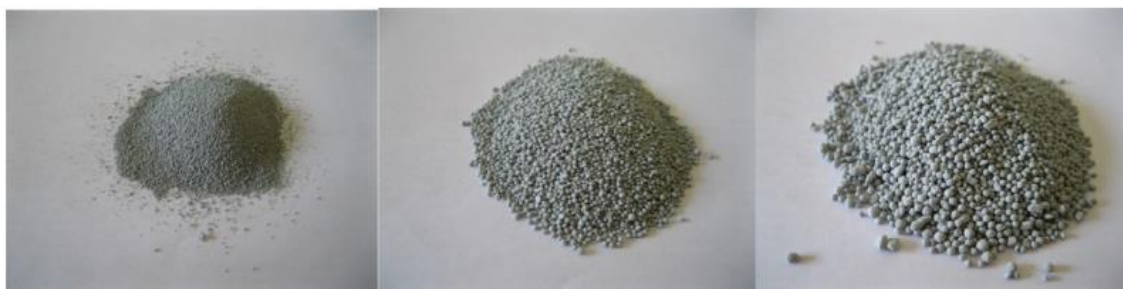
Figura 4 - Sílica ativa com diferentes granulometrias
