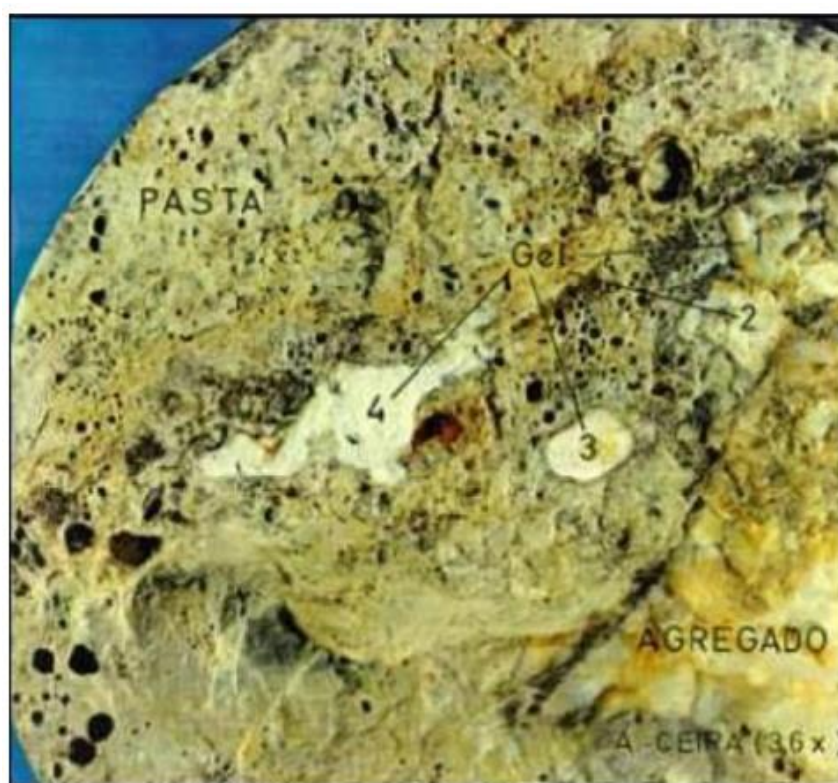
Figura 15 - Reação álcali-sílica reativa Estados de alteração (1 a 4) de quartzo – filoneado em gel.
