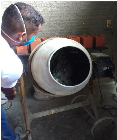
Figura 26 - Betoneira utilizada no preparo dos concretos
