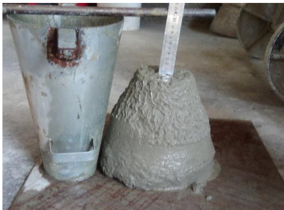
Figura 27 - Aparência do concreto no momento da aferição da consistência
