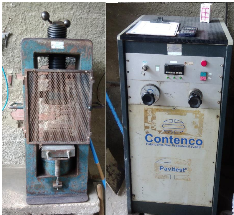
Figura 28 - Prensa hidráulica utilizada nos ensaios de compressão
