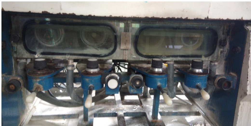
Figura 20 - Detalhe do processo de lapidação com discos de desbaste e água
