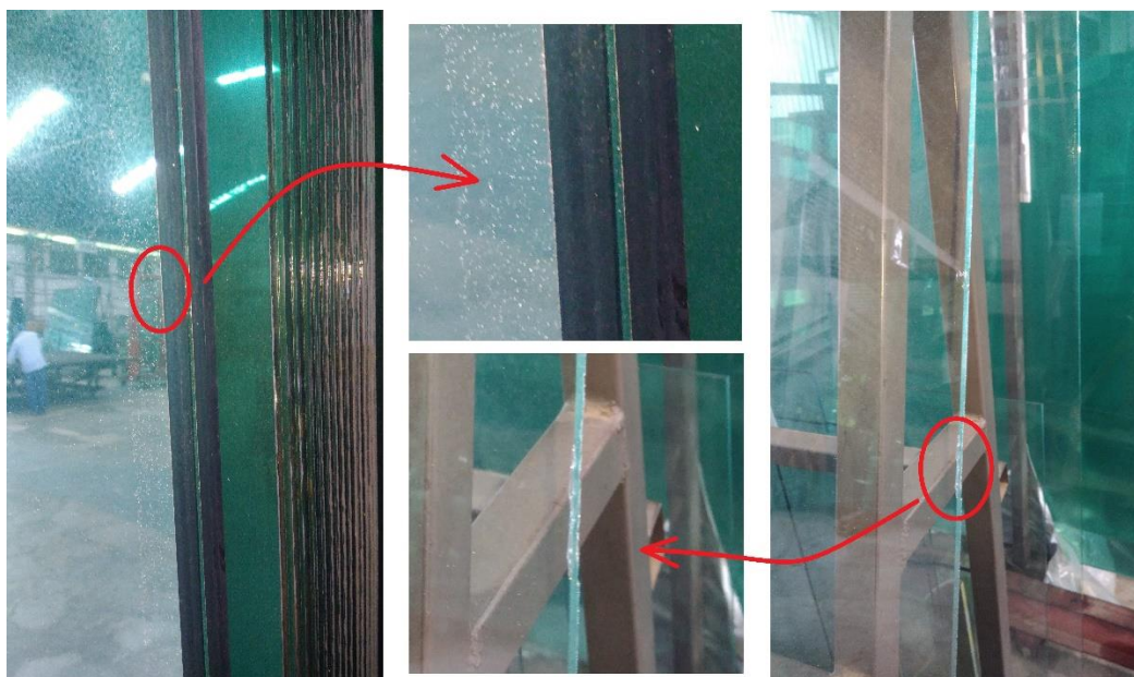
Figura 19 - Detalhe da aresta cortante da chapa de vidro após corte da peça
