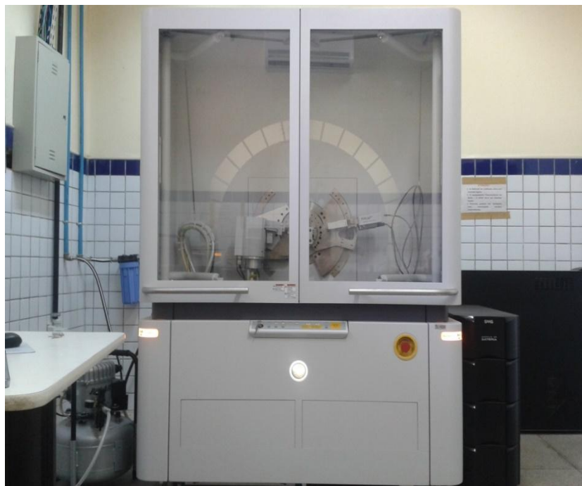
Figura 5.10: Aparelho utilizado na análise de difração de Raio-X
