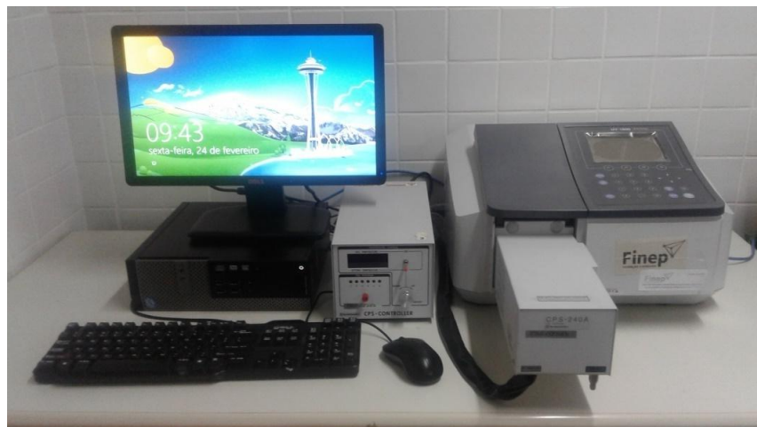
Figura 5.9 Aparelhagem utilizada na análise de UV-VIS
