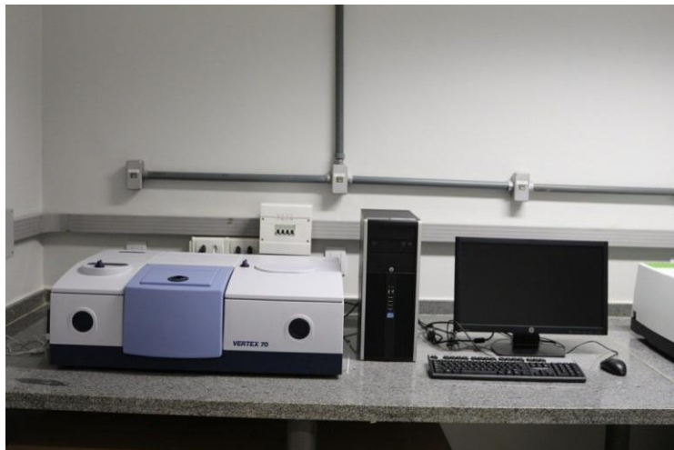
Figura 5.6 Aparelhagem utilizada na análise de FTIR.
