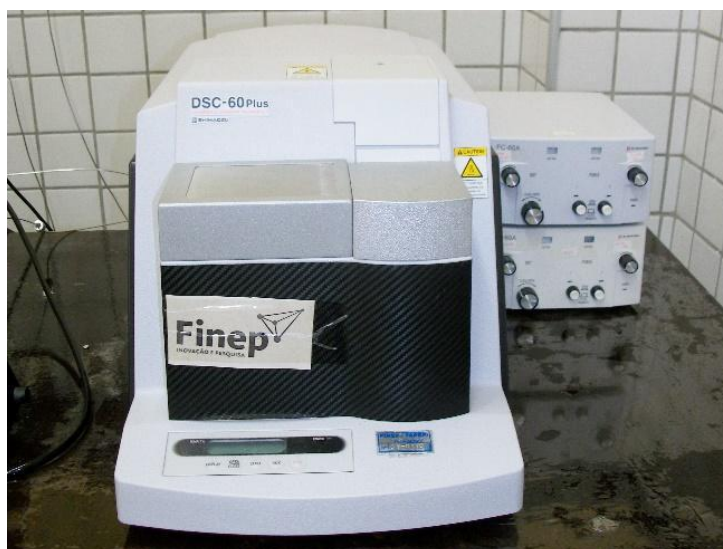
Figura 5.8. Aparelhagem utilizada na análise de DSC.
