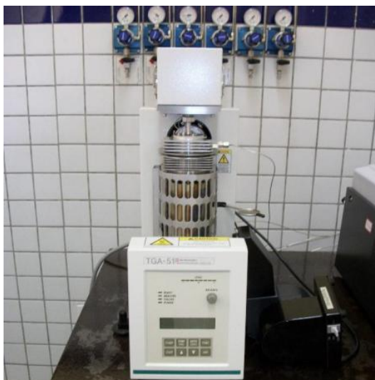
Figura 5.7 Aparelhagem utilizada na análise de TGA.
