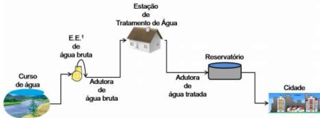
FIGURA 1- ESTAÇÃO DE TRATAMENTO DE ÁGUA (ETA)
