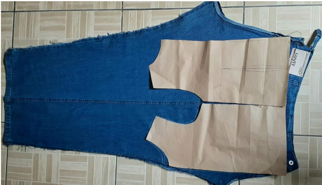
Foto 2. Molde da jaqueta já sobreposto na calça jeans com as costuras desfeitas, para ser cortadas as partes que irão compor a jaqueta.
