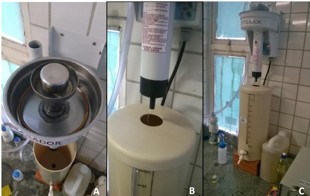
Figura 14: Componentes do destilador do Campus. Fonte: Produção original, 2017.
