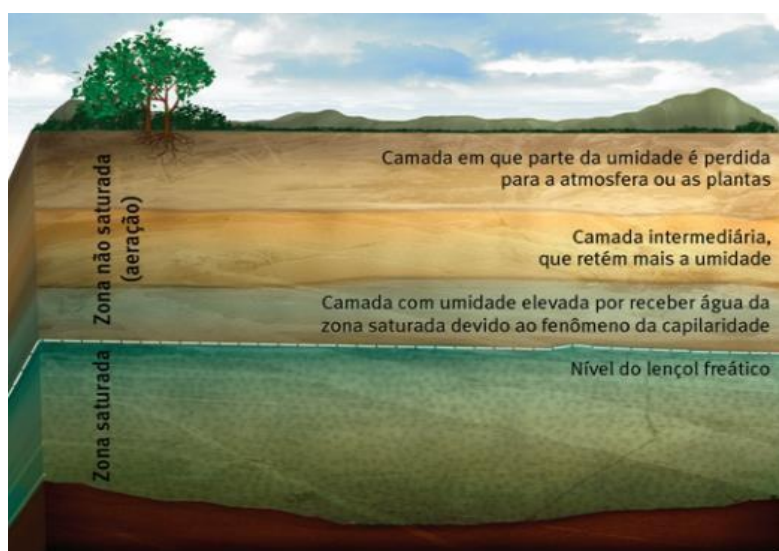
Figura 2. Zonas saturada e não saturada do solo.
