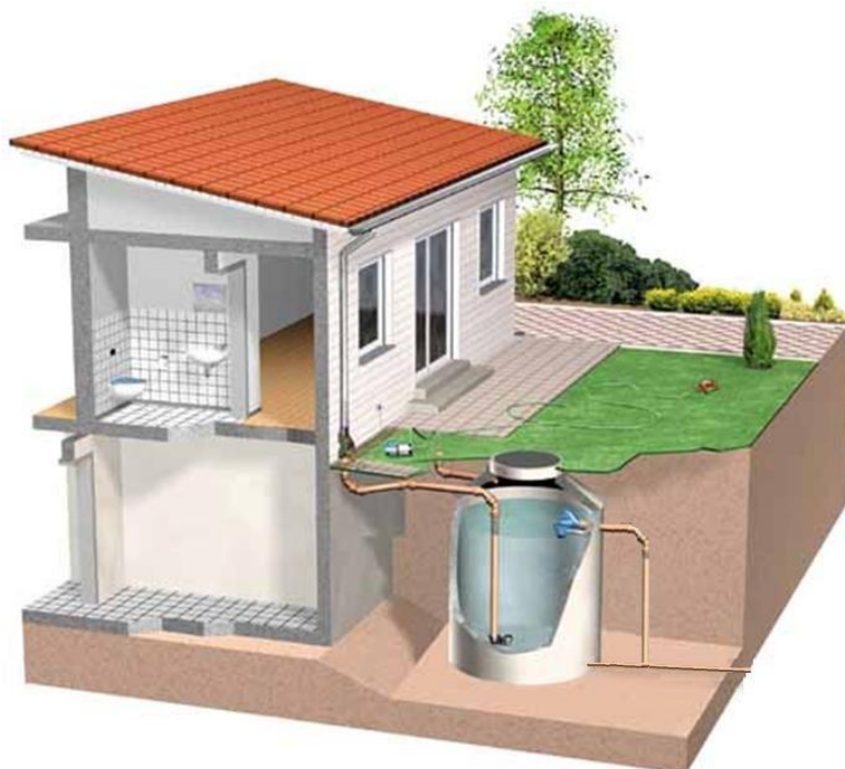
Figura 5 – Exemplo de micro reservatório enterrado
