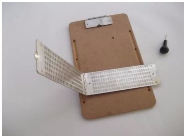
Figura 1 – Máquina de escrever braille (reglete)
