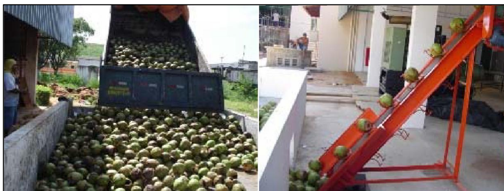
Figura 7 – Processo de descarga das CCV e elevação para trituração
