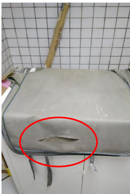
Figura 20: avental plumbífero em péssimo estado de conservação e limpeza.
