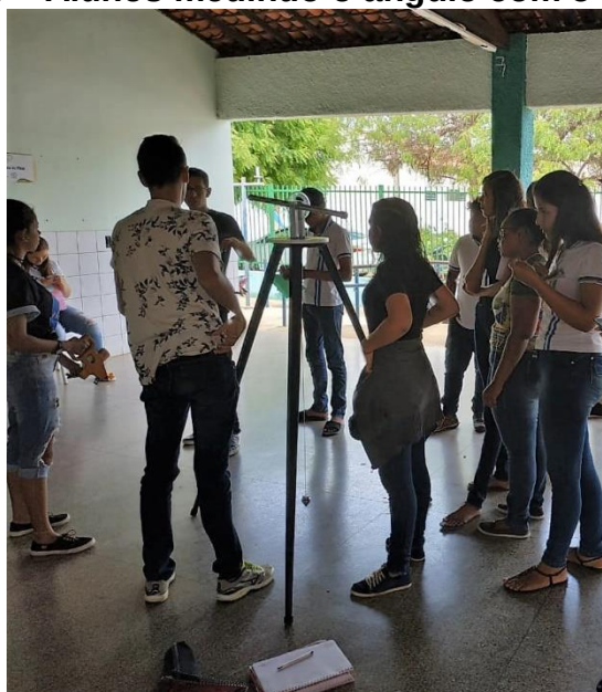
Figura 5 – Alunos medindo o ângulo com o teodolito
