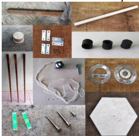
Figura 2 – Materiais usados na construção do Teodolito
