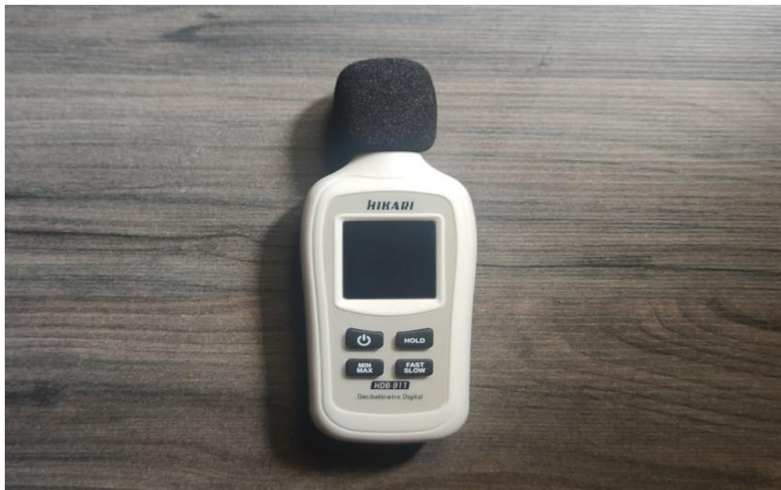
Fotografia 4 – Decibelímetro utilizado para medição de nível de pressão sonora
