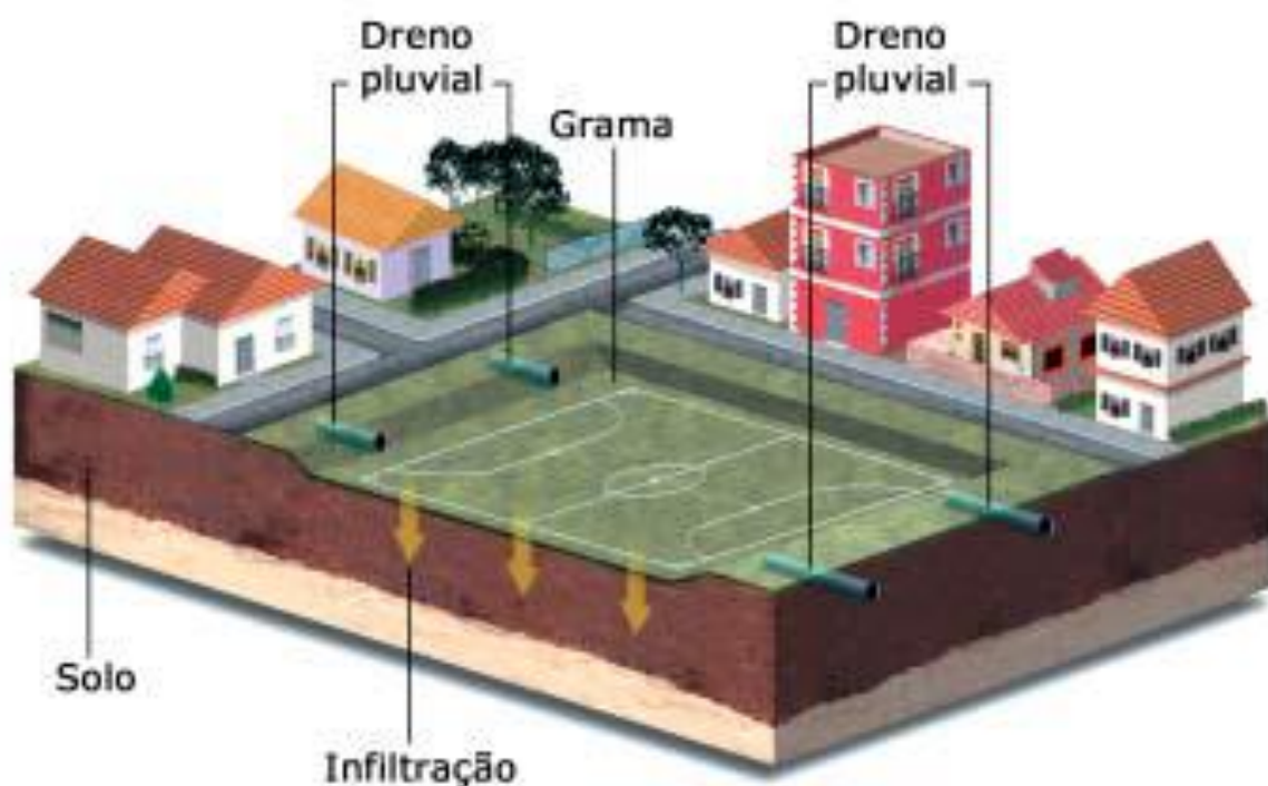
Figura 9: Reservatório de retenção de múltiplos usos.
