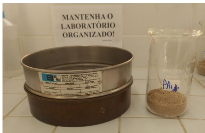
Figura 9 - Processo de Granulometria da amostra
