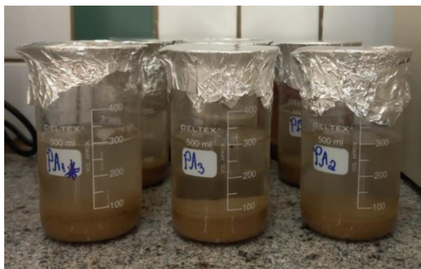
Figura 10 - Amostras em processo de flotação
