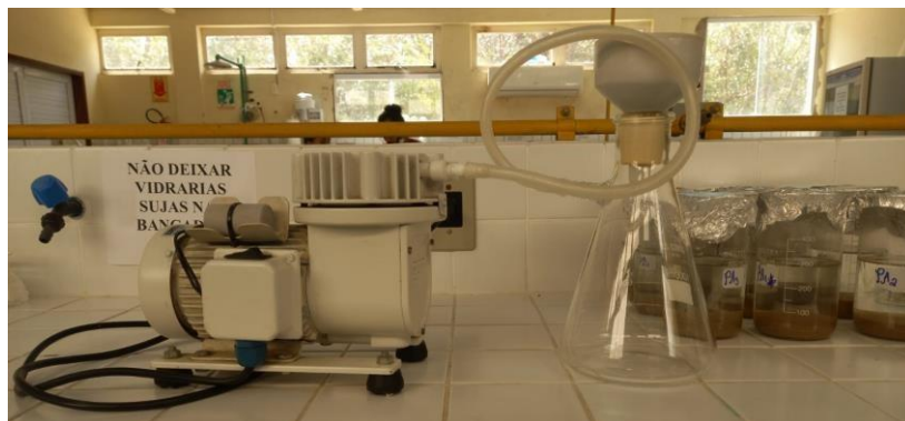
Figura 11 - Sistema montado do processo de filtração da amostra
