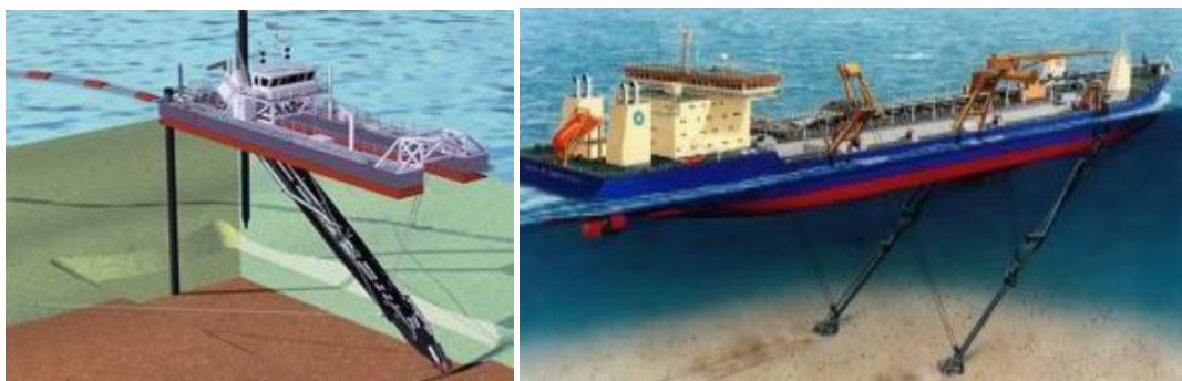
Figura 4: Dragagem de Sucção e recalque versus Dragagem Mista
