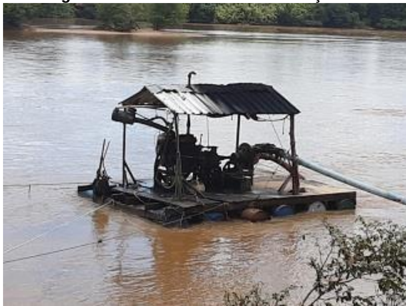
Figura 15: Dragagem utilizada na atividade de extração de areia
