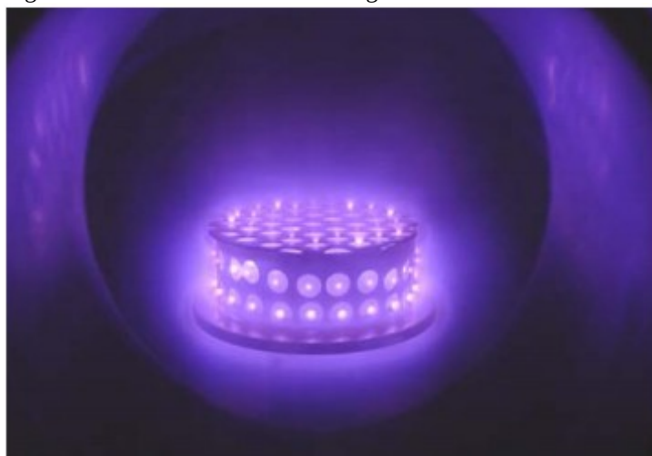
Figura 12. Plasma sendo formado na gaiola catódica
