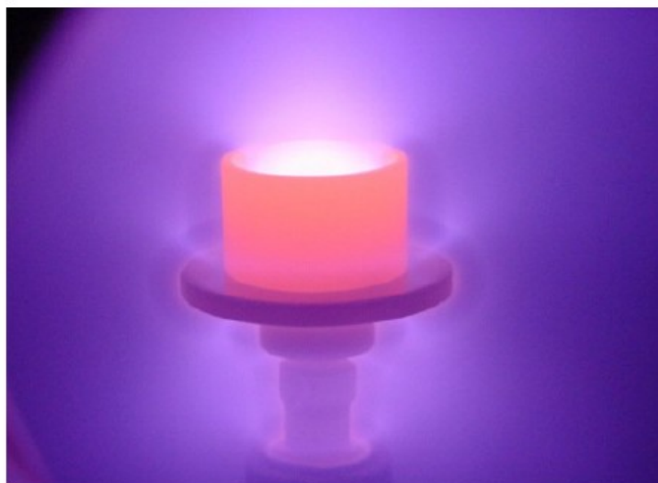
Figura 9. Efeito de cátodo oco em um cilindro via descarga CC.
