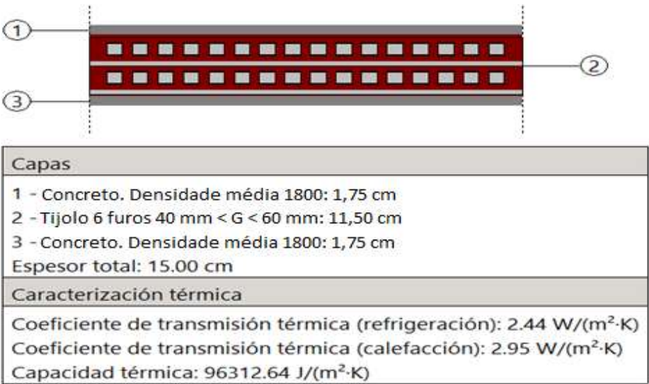
FIGURA 29: COMPOSIÇÃO ESTRUTURAL DA PAREDE EXTERNA SUPERIOR
