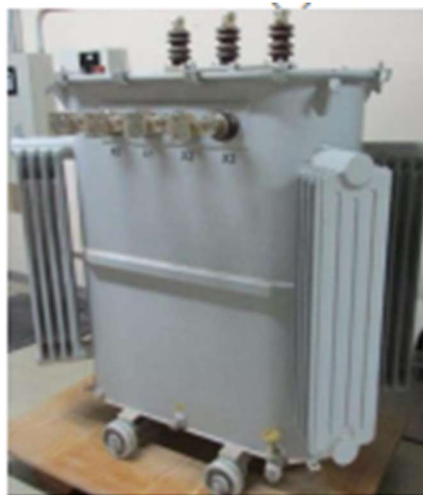
FIGURA 5: TRANSFORMADOR COM ISOLAMENTO A ÓLEO
