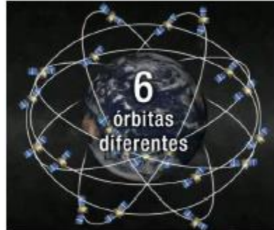
Figura 17: Constelação dos satélites do sistema GPS.
