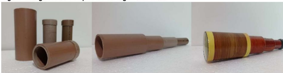
Figura 10: algumas das etapas da montagem da Luneta
