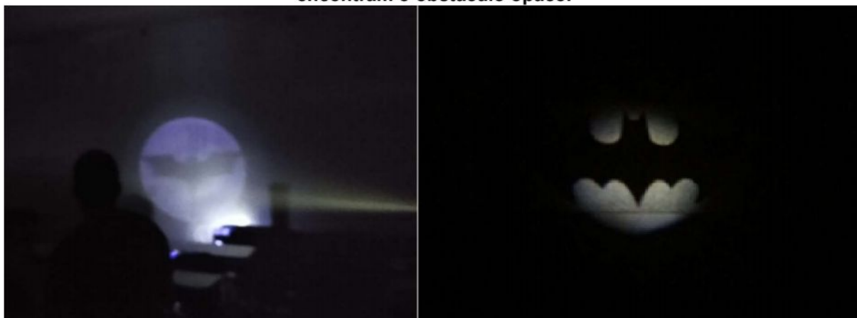
Figura 6: Imagem da sombra projetada pelo aparato quando os feixes luminosos da lâmpada encontram o obstáculo opaco.
