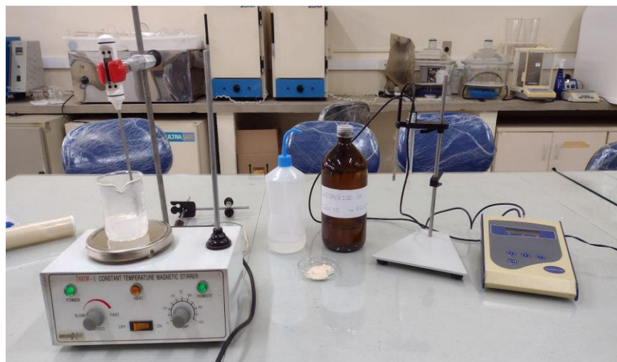
Figura 7 - Ensaio de condutividade elétrica – Luxán et al. (1989)
