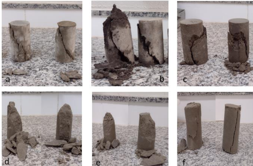
Figura 18 – Corpos de prova rompidos após o ensaio de resistência
