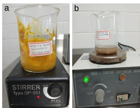
Figura 4 Etapa de agitação das amostras de dendê (a) e coco babaçu (b).
