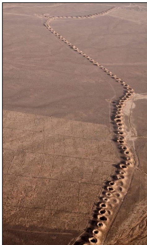
Figura 01 - Sistema de canais de Qanats.
