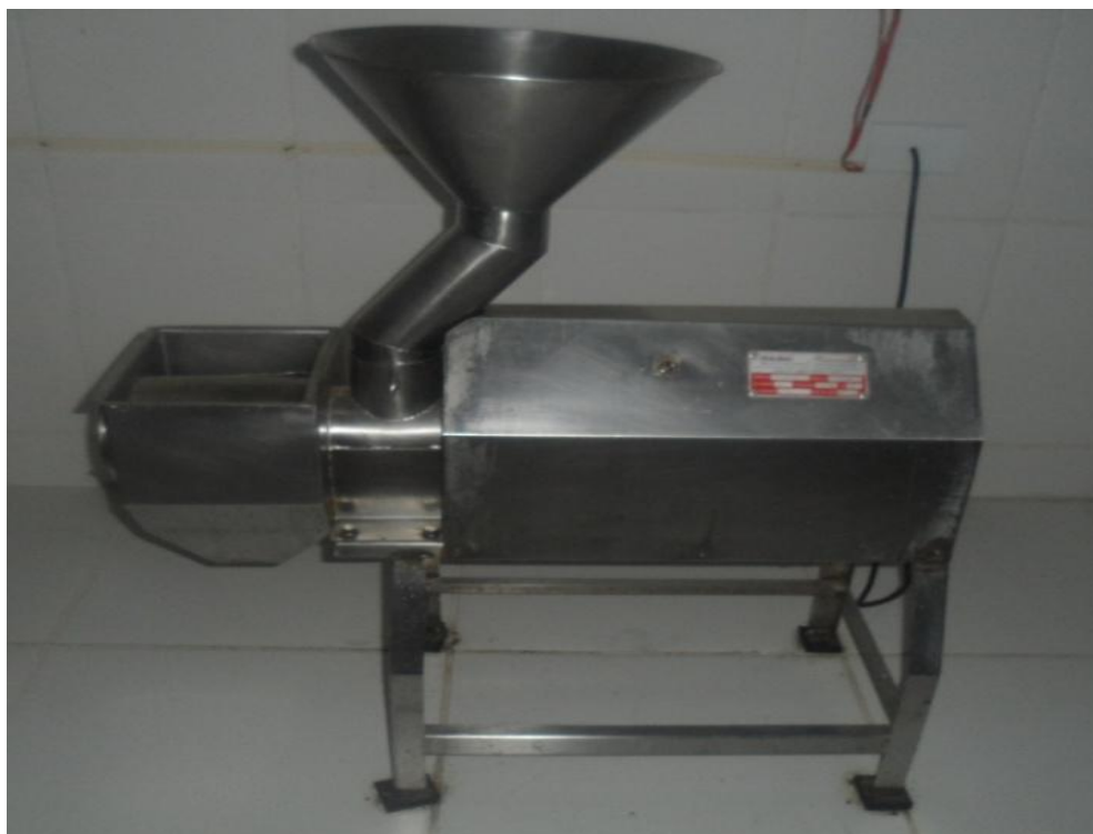
Figura 09 - Despolpadeira de caju pertencente à Cooperativa Novo zabelê
