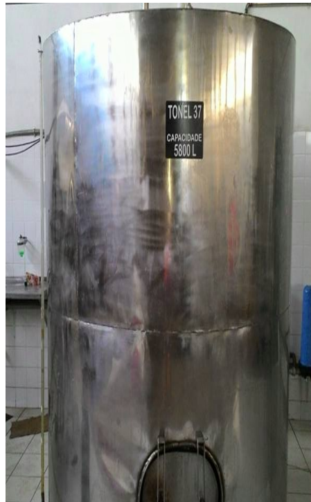
Figura 34 - Tonel de alumínio de destilação da cachaça
