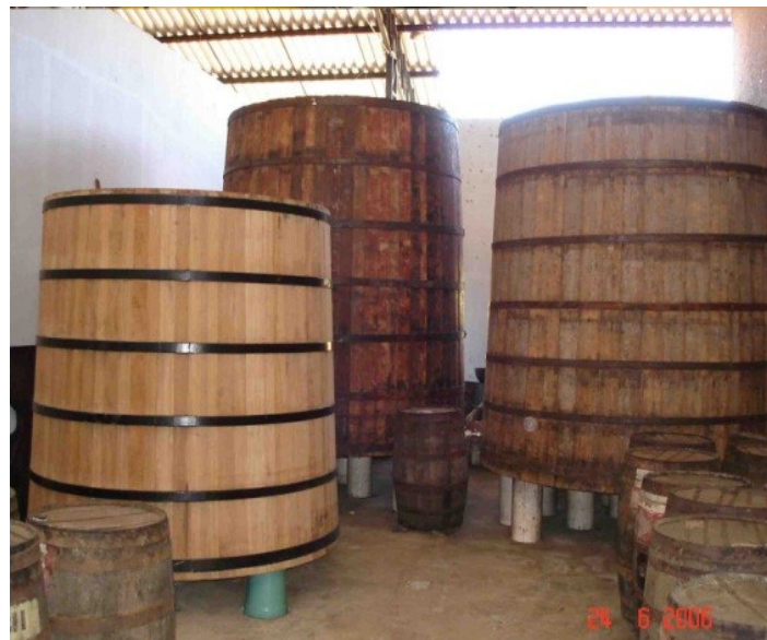
Figura 35- Tonel de madeira de destilação da cachaça
