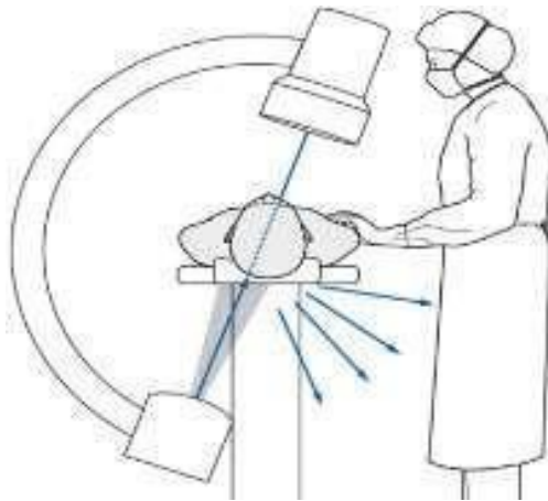
Fig 4. Irradiação refletida (scattered radiation)
