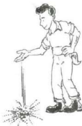
Figura 30– Determinação da umidade ótima do solo
