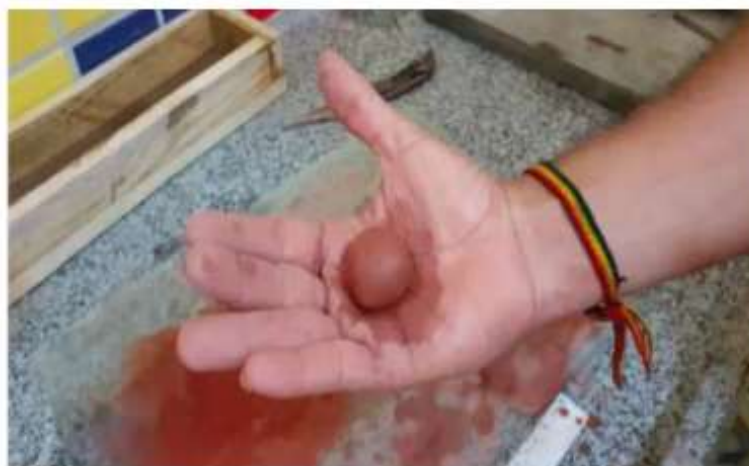
Figura 42- Ensaio do bolo- bolo antes de ser golpeado
