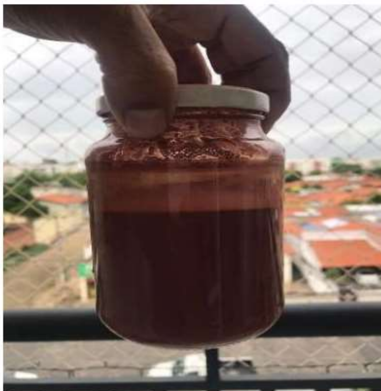
Figura 37 – Ensaio do vidro – presença maior de argila
