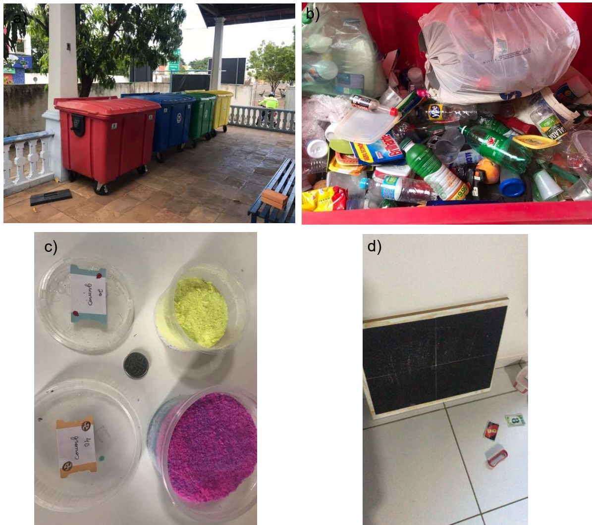
Figura 13—a) Ponto de recolhimento de descartáveis b) Embalagens de PET; c) PET pulverizado; d) Lixa usada para ralar o PET
