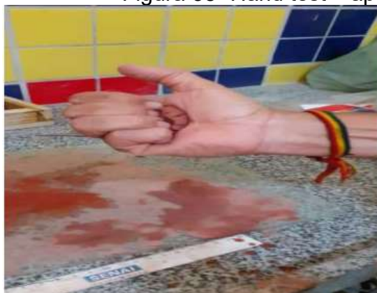
Figura 38- Hand test – apertando a argila entre os dedos
