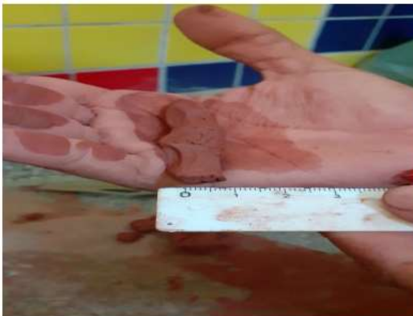
Figura 41- Ensaio da fita- cilindro amassado acima de 3 mm
