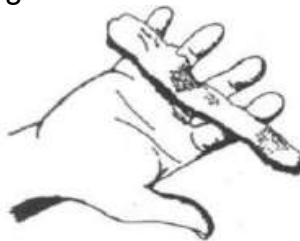
Figura 32- Ensaio da fita
