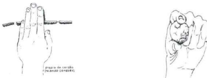
Figura 31- Ensaio do cordão
