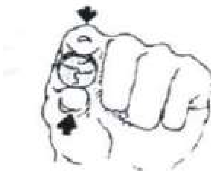
Figura 34- Ensaio da resistência seca
