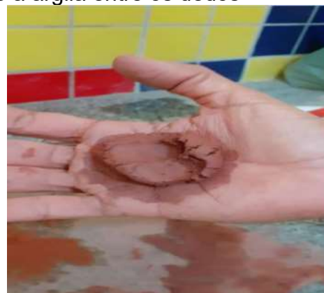
Figura 38- Hand test – apertando a argila entre os dedos
