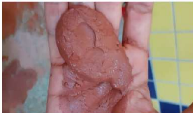
Figura 43- Ensaio do bolo- bolo com a pressão dos dedos
