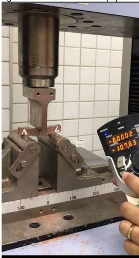
Figura 25 - Ensaio de flexão (3 pontos)
