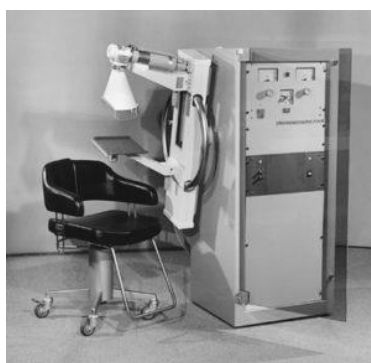
Figura 1: Senographe primeiro equipamento destinado à mamografia
