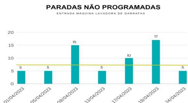
Figura 19 – Paradas não programadas na máquina LGV
