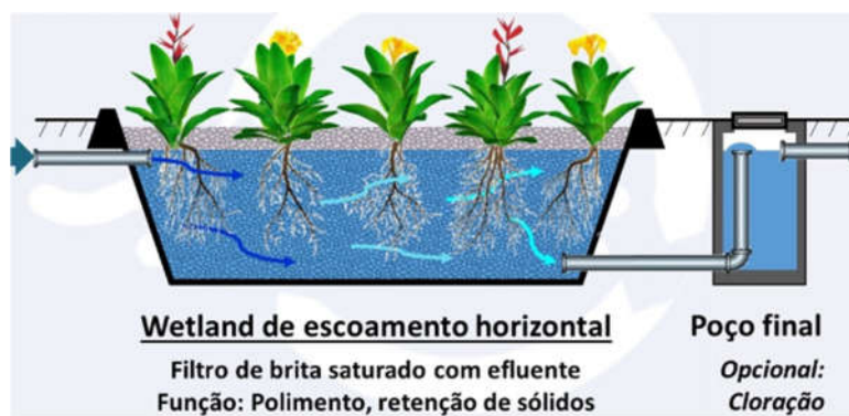
Figura 18 - Esquema da ETE Compacta por Zona de Raízes da Rotária do Brasil
