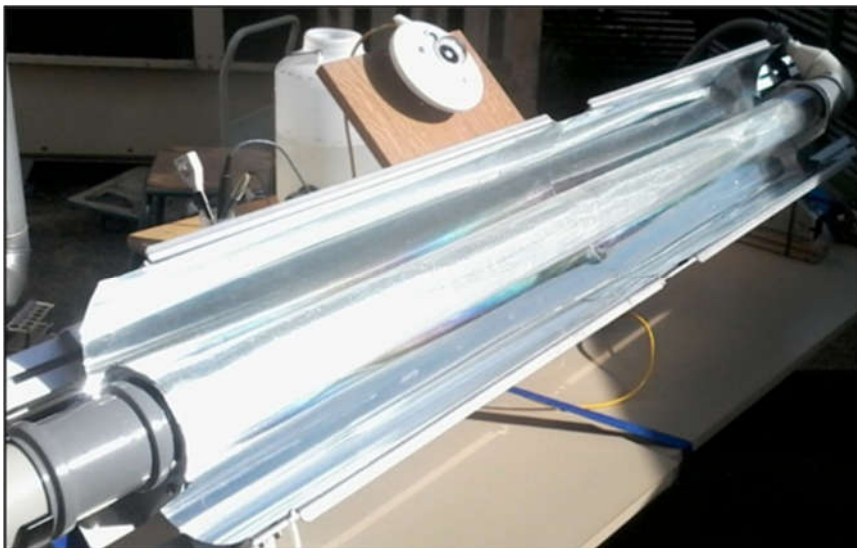
Figura 42 - Esquema do CPC Proposto por Gutiérrez-Alfaro e Colaboradores
