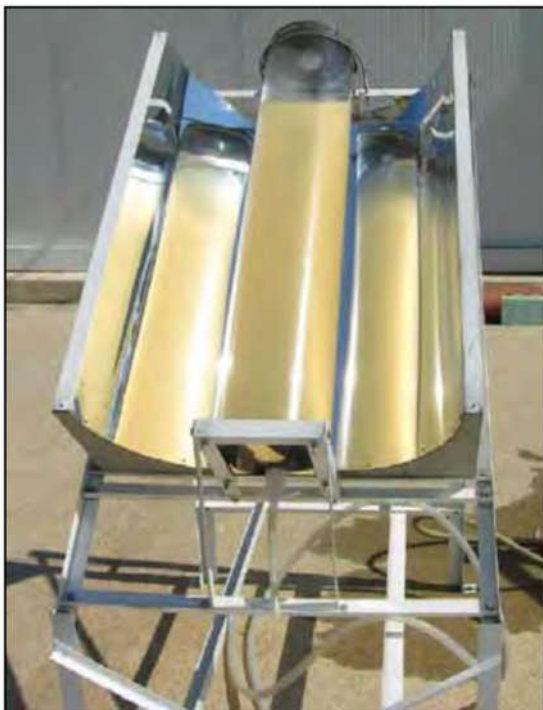
Figura 40 - Esquema do CPC Proposto por Ubomba-Jaswa e Colaboradores
