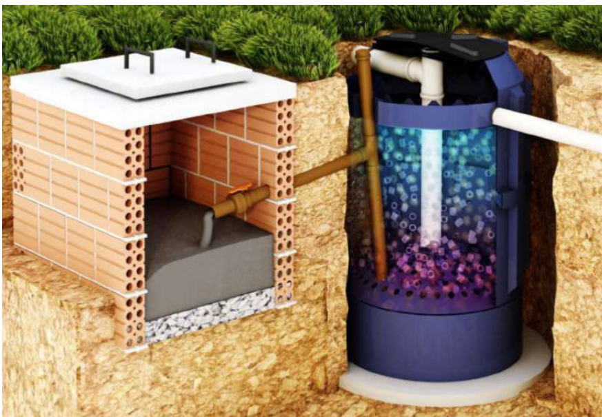
Figura 5 - Esquema da ETE Compacta Anaeróbia da Fortlev
