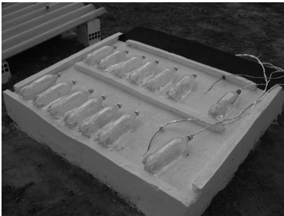
Figura 35 - Esquema do SODIS Proposto por Botto e Colaboradores
