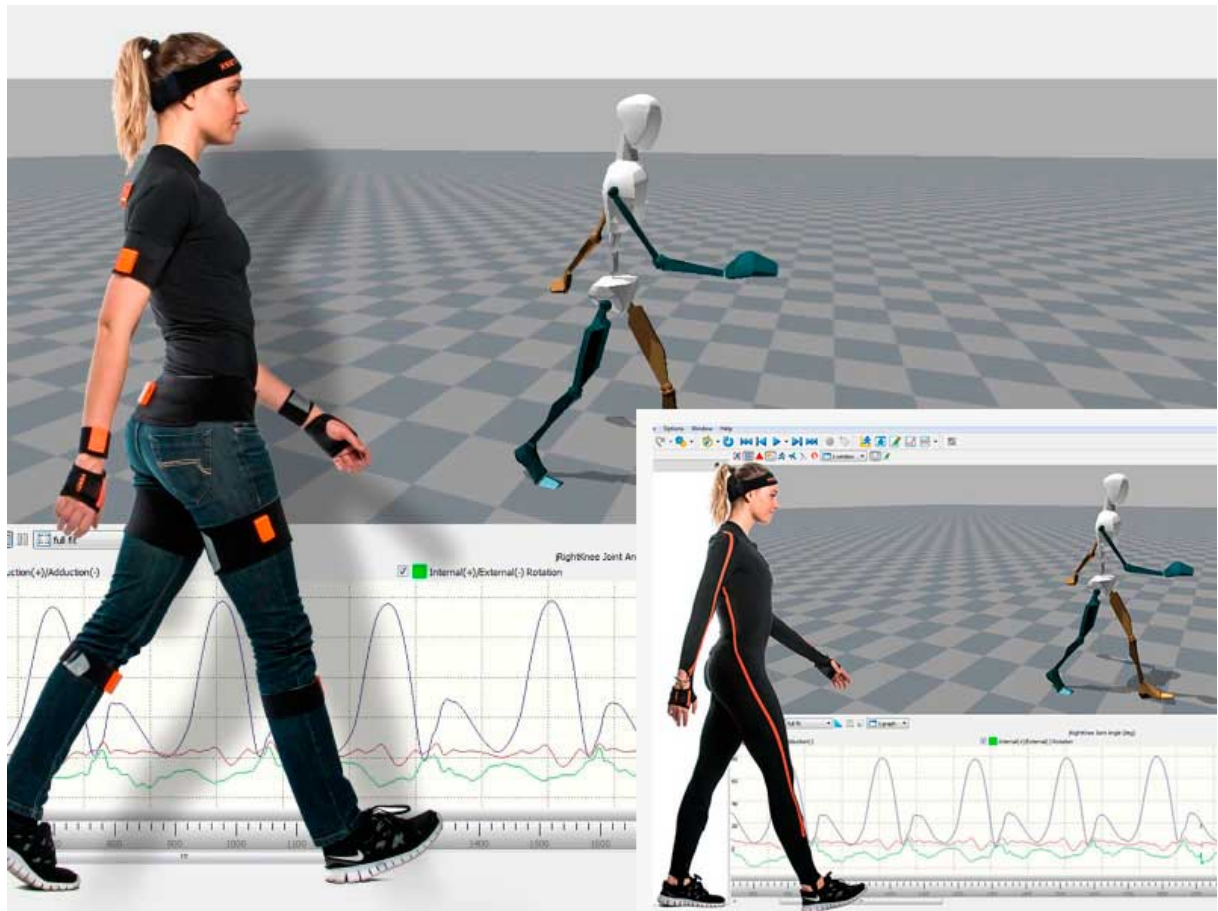
Figura 3: XSens MVN Biomech™ - Exemplo de roupa com sensores inerciais
